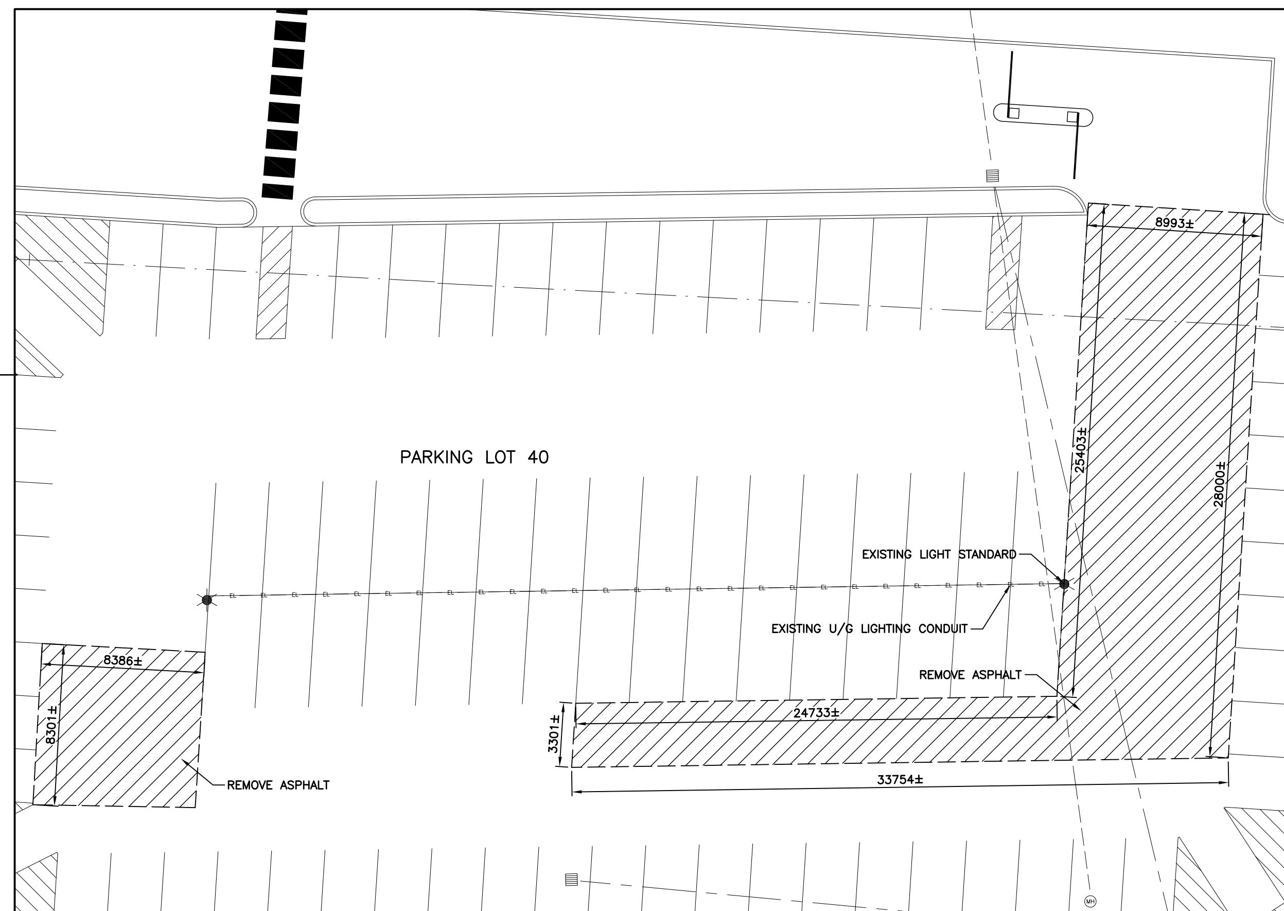
DEMOLITION SITE PLAN SCALE: 1:200
